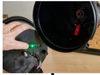
Visualizzatore stato batteria esterno
