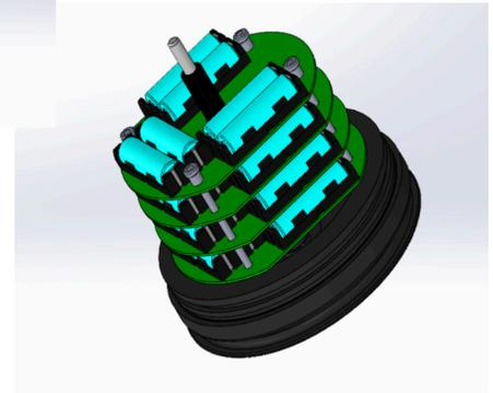
Finalmente prende forma la prima soluzione modulare a celle standard Li-ion per poter trasportare il proprio scooter subacqueo su un volo aereo rispettando le rigide regole IATA e dei vari vettori.
